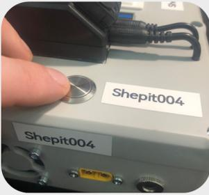
Натиснути металеву круглу кнопку на корпусі ретранслятора для переходу в **режим очікування**. На корпусі засвітиться відповідний світлодіод.
