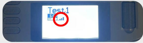
При включеному ретрансляторі та пульті, на пульті з'явиться індикація встановленого зв'язку
