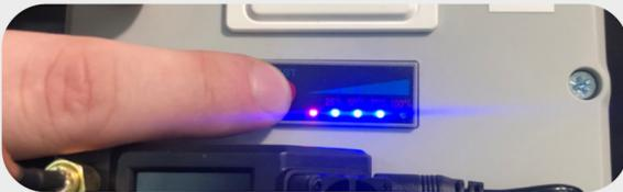
В режимі очікування та під час роботи можна перевірити рівень заряду
