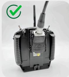
Під'єднайте міжблочний кабель до ретранслятора та проведіть інший кінець до вашого укриття
