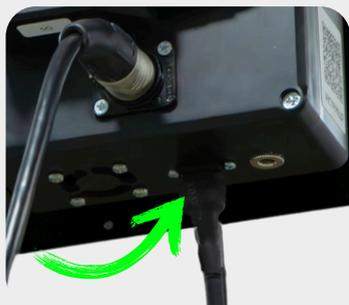
Дротова подача живлення можлива за допомогою кабеля з роз'ємами XT-60 та підключенням до нього зовнішнім акумулятором від 12В до 25В.
