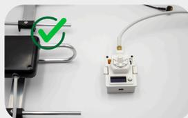
Встановіть JR модуль керування у відповідне місце та під'єднайте кабелі патч та Helix антен до роз'ємів відеоприймача
