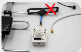
Перед встановленням модуля керування під'єднайте кабель антени ЯГІ на відповідну частоту
