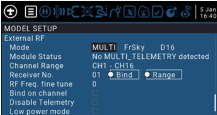
请长按MDL按钮进入模型设置，在MODEL SETUP页面中选择MULTI，并在子选项中选择需要使用的协议。
