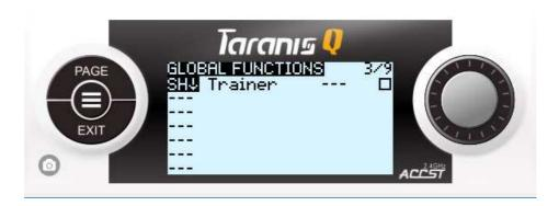
Выбираем следующее поле справа и выставляем там "RESET", в третьем поле - Tmr1. Ставим галочку в последнем. Жмем "EXIT" чтобы выйти из редактирования.
