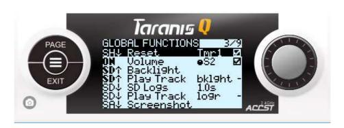
Выбираем первую пустую строку, жмем "ENTER" и двигаем переключатель SH на себя чтобы получить его значение "SH  $\downarrow$ ", жмем "ENTER" еще раз для сохранения значения.
