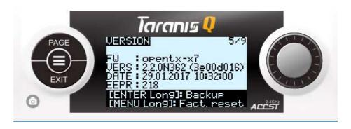
Здесь вы можете проверить текущую версию прошивки аппаратуры. "VERS" должна соответствовать сборке прошивки, которую вы только что загрузили.
