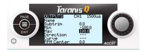
• Выберите поле значения "SUBTRIM", нажмите "ENTER". Смотря на закладку монитора каналов конфигуратора полетного контроллера, начинайте вращать колесо управления пока значение элеронов не станет точно "1500". Нажмите "EXIT" для подтверждения текущего значения.
