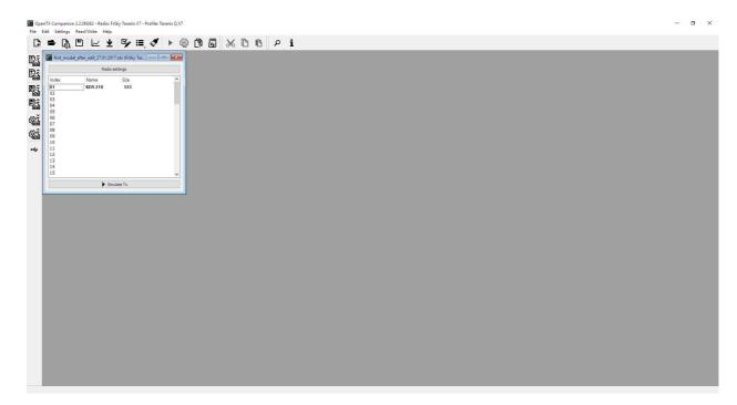
После выбора READ/WRITE -> "Read models and settings from radio", двойной клик на имени модели приведет вас на экран с закладками всех настроек модели. Чтото проще настраивать на ПК, что-то проще настраивать в аппаратуре. Экспериментируйте. Нажмите READ/WRITE -> "Write models and settings to radio" чтобы сохранить изменения в аппаратуру.
