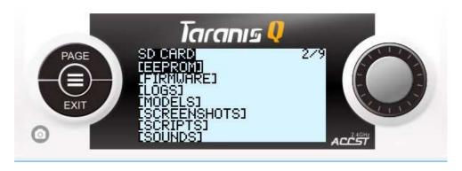
Вращаем колесо управления чтобы попасть в папку "FIRMWARE", нажимаем «enter», ищем файл прошивки, удерживаем "ENTER" на нем и выбираем Update bootloader. Все, ваш загрузчик обновлен и имеет такую же версию, как и прошивка. Нажимает "EXIT" несколько раз чтобы вернуться на полетный экран.
