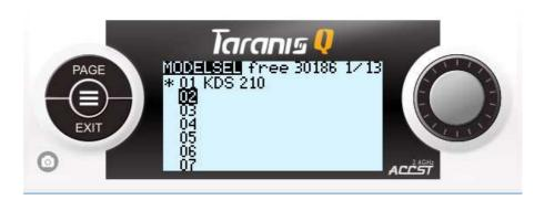
\*заметка: если вы создаете новую модель, первые 4 канала автоматически будут выставлены в порядке, заданном вами в настройке аппаратуры "RADIO SETUP" (в моем случае AETR). Поэтому мы и задали этот порядок ранее. Существующая модель с завода в вашей аппаратуре имеет другой порядок первых каналов. Я предпочитаю удалить такую модель и создать новую.
