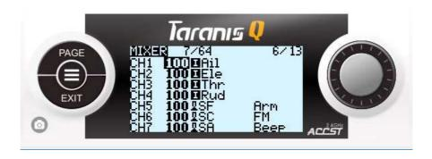
Перевод: СН7 приемника получит 100% (полное значение) переключателя SA (-100 в верхнем положении SA, 0 (в центре) и +100 в нижнем).
