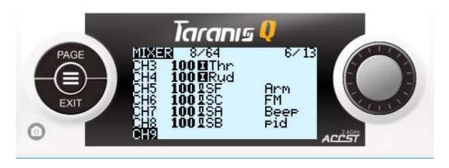
Перевод: CH8 приемника получит 100% (полное значение) переключателя SB (-100 в верхнем положении SB, 0 (в центре) и +100 в нижнем).
