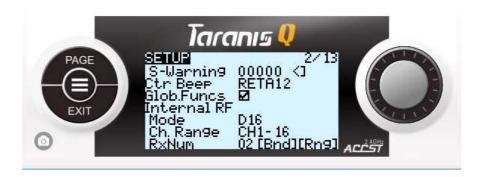
Нажмите и удерживайте кнопку BIND на приемнике и подайте на него питание. Отпустите кнопку BIND. Выключите приемник. Нажмите "EXIT" на аппаратуре
