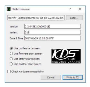
Программа покажет вам файл прошивки, которую она собирается записать в аппаратуру и ее версию. Нажмите "Write to TX" и ждите ожидание процесса обновления. Все, аппаратура обновлена до последней версии OpenTX.
