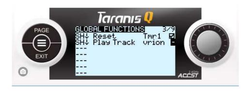
Нажимаем "EXIT" несколько раз пока не выйдем на полетный экран. Проверяем как работают наши Timer1 и Timer2. Timer1 начнет отсчитывать назад когда мы переставили SF в положение ARM и сдвинули стик газа вверх. Он будет идти пока мы не сбросим его переключателем SH на себя. Звук сброса таймера тоже должен прозвучать в этот момент.
