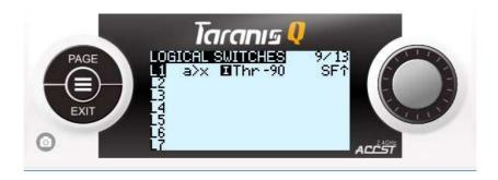
С помощью логического переключателя L1 мы будем запускать таймер1 при определенных условиях. Теперь нам нужно научить идти постоянно, без остановки, даже если эти условия сначала были выполнены, а потом перестали выполнятся. И так до самого сброса таймера1 на первоначальное значение..
