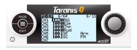
Перевод: CH6 приемника получит 100% (полное значение) переключателя SC (-100 в верхнем положении SC, 0 (в центре) и +100 в нижнем).
