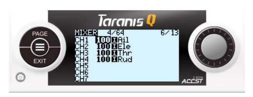
Это основополагающий экран настройки модели. Микшеры отвечают за поведение каналов, которые передаются на приемник из аппаратуры. Сейчас, у нас на экране только 4 первых микшера созданные как 4 первых канала в порядке AETR и которые говорят о том, что делают наши стики и на каком канале. Давайте переведем первую строку на человеческий язык:
