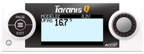
Этот экран отображает значения датчиков телеметрии, которые вы установили для отображения. Таких экранов может быть 4 для модели (переключение между ними коротким нажатием «PAGE») и каждый может отображать до 8 показаний = 32 значения максимум. Нажмите "EXIT" чтобы выйти на полетный экран.
