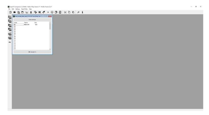
Нажатие на верхнюю кнопку "Radio settings" отправит вас к закладкам настройки аппаратуры. Внесите изменения, перейдите к "READ/WRITE" -> "Write models and settings to radio" для их сохранения в память аппаратуры.
