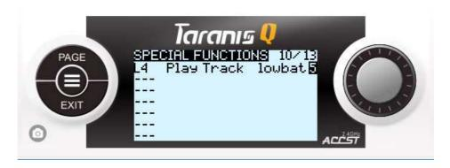
Перевод: специальная функция (проигрывание указанного звукового файла) начнет работать при начале работе логического переключателя L4 и будет повторяться каждые 5 секунд.
